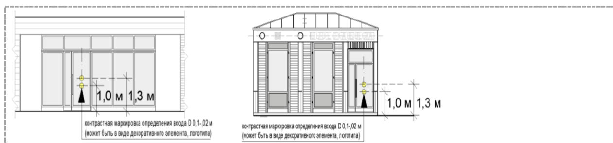
Рис. «Внешний вид контрастной маркировки входа»
